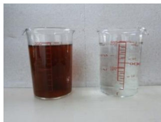
産廃業者廃液 AOPplus処理後凝集沈殿
